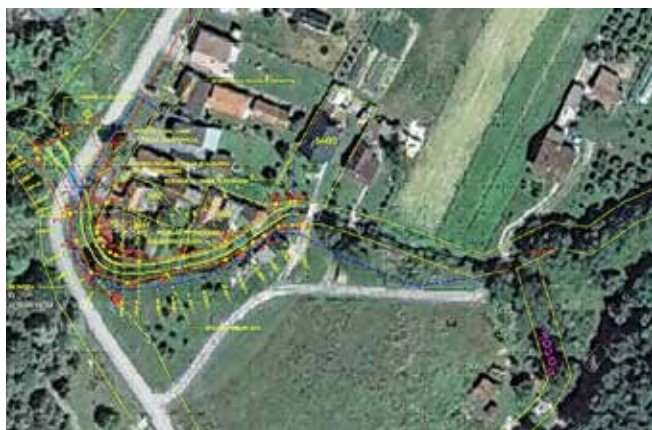
Regulacija korita potoka Potočani na dionici 2 od km 1+787 do km 1+900 u duljini 113 m
