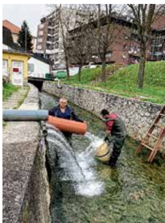
Mjerenje istjecanja termalne vode na izvorištu u Krapinskim Toplicama (Izvor: IGH, 2022.)
