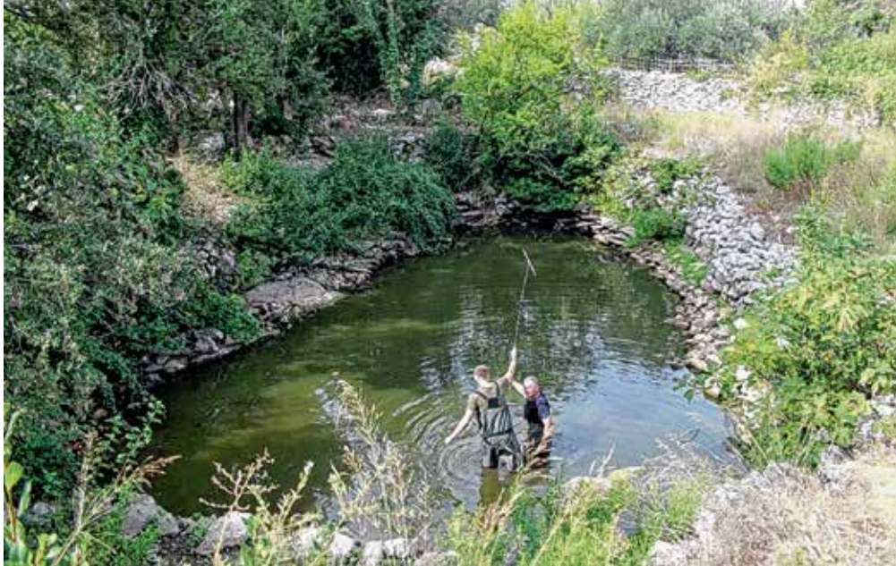
Primjer ispitivanja debljine vode i sedimenata pomoću metalnih šipki u lokvi Prljevići (Izvor: HGI)
