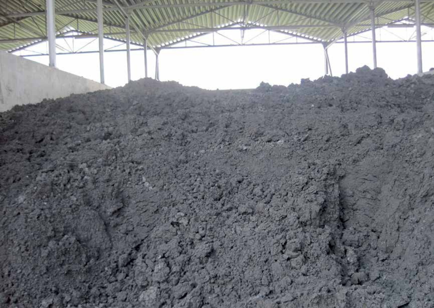
Otpadni mulj, u procesu njegove anaerobne stabilizacije nastaje bioplin – važan obnovljivi izvor energije na UPOV-ima
