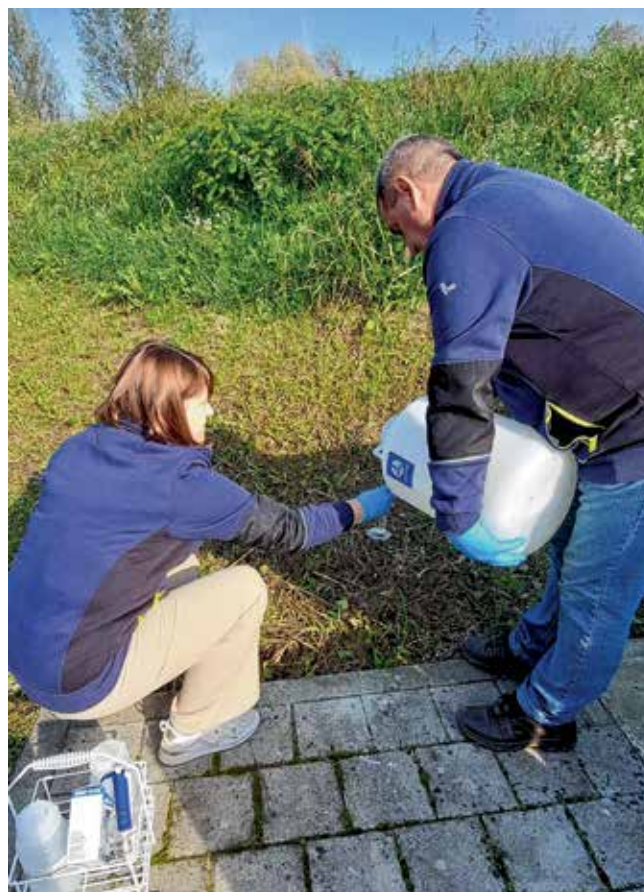
Uzorkovanje otpadne vode na izlaznom oknu uređaja za pročišćavanje u Sisku
